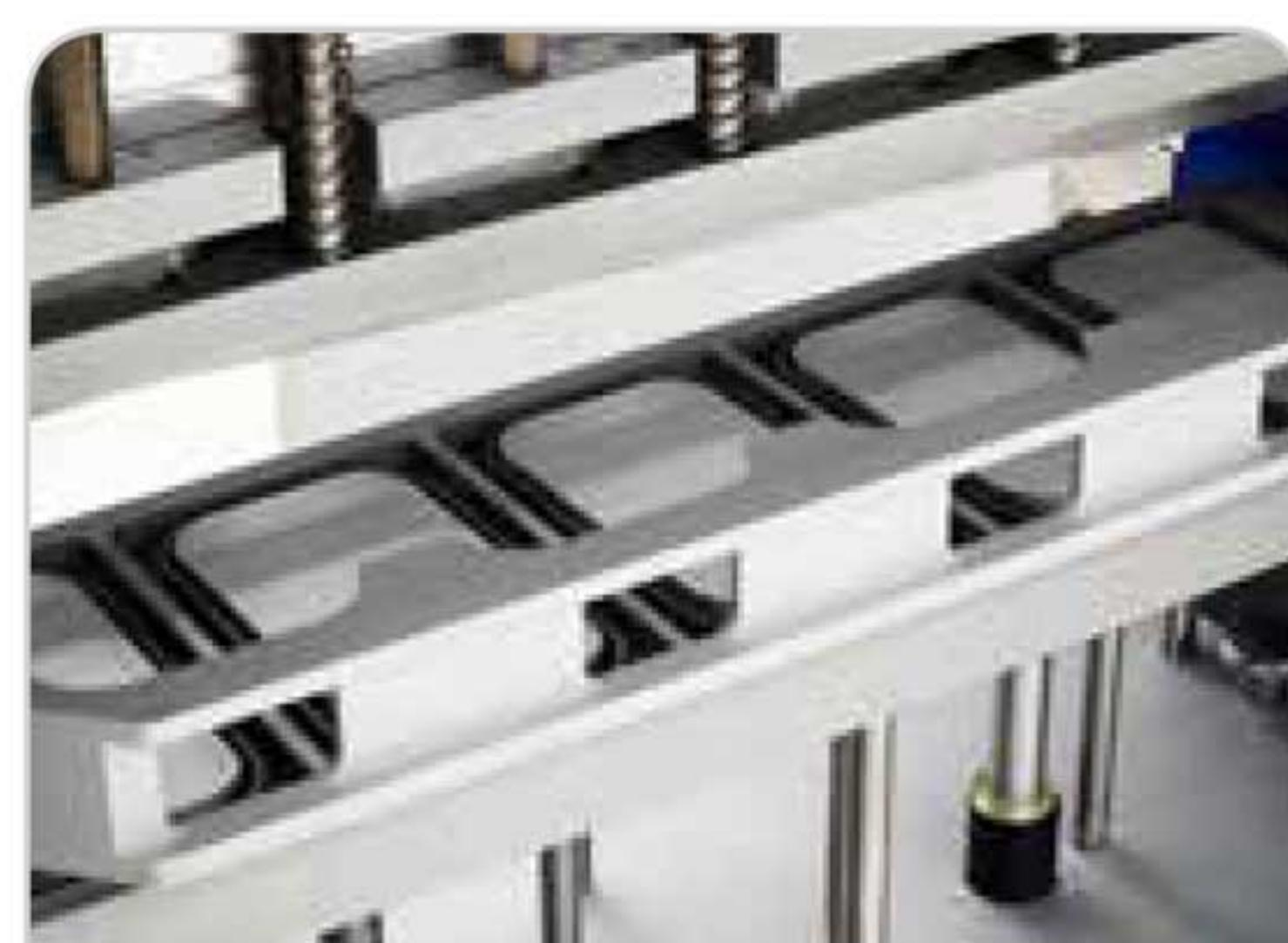
Transporte de bandejas mediante sistema de brazos de gran fiabilidad
