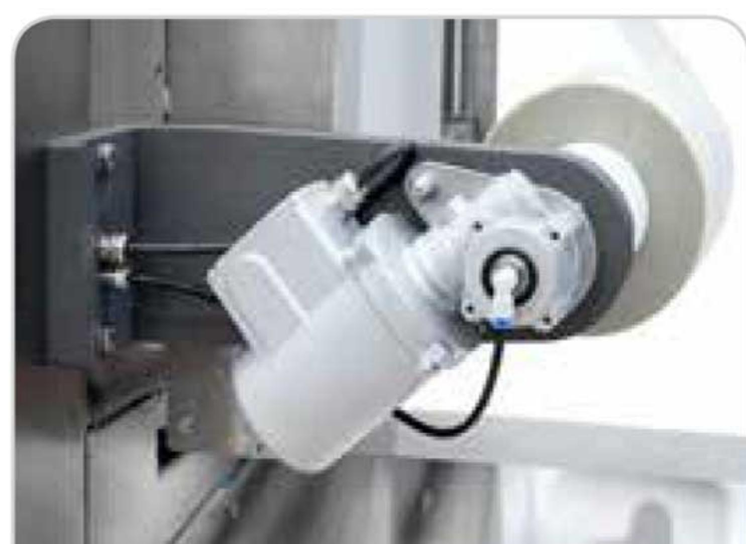
Portabobinas motorizado con control de tensión
